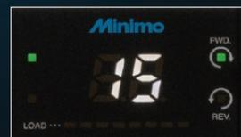
モーターを識別し、回転数または、出力レベルを自動的に切替えデジタル表示します。
